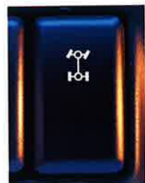
Eine von vielen Innovationen im Frontera. Das No-Stop-Allrad-System N.S.A. Umschalten auf 4x4-Antrieb, elektronisch, ohne anzuhalten, bis zu 100 km/h.
