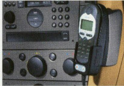
Fahrzeugspezifische Telefonkonsole, Halterung und Freisprecheinrichtung (erhältlich für alle gängigen Telefon-Modelle von Nokia, Siemens, Ericsson, Motorola, Alcatel) für eine sichere und komfortable Kommunikation.
