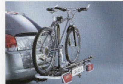
Heckfahrradträger zur Montage an der Anhängerzugvorrichtung, mit spezieller Schnellmontagevorrichtung und Erweiterungsmöglichkeit für ein drittes Fahrrad.
