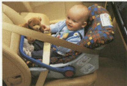
Kindersicherheitswiege (bis 10 kg Gewicht), mit Transponder zur automatischen Deaktivierung des Beifahrerairbags in Fahrzeugen mit Sitzbelegungserkennung. Empfohlen mit Sonnenblende und Babykissen.
