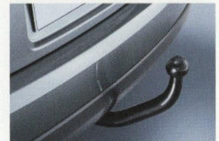
Anhängerzugvorrichtung mit starrem oder abnehmbarem Kugelkopf für zusätzliche Sicherheit. Zuglast max. 1950 kg. Für bessere Sicht nach hinten bitte separaten asphärischen Außenspiegel bestellen.
