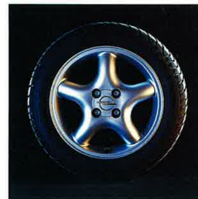
Leichtmetallrad 5 1/2 J x 15 im Pentaline-Design mit Reifen 185/55 R 15-81 H. (Sonderausstattung für 1.4 16V)
