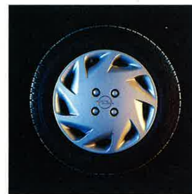
Stahlräder 5 1/2 J x 14 mit Reifen 175/65 R 14-82 H.
