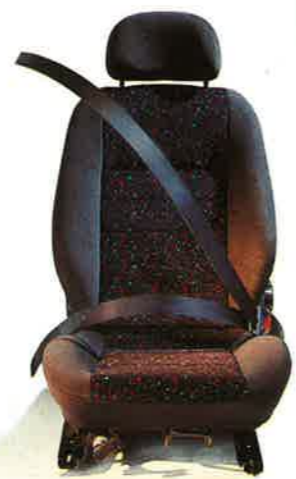
Das Opel Aktivgurt-System für erhöhten Insassenschutz. Mit variabler Gurthöhen-einstellung und Gurtschloßstraffern.
