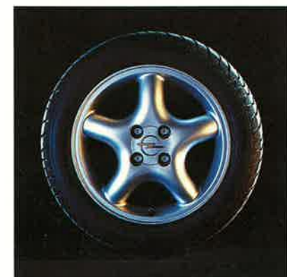
Leichtmetallrad 5 1/2 J x 15 im Pentaline-Design mit Reifen 185/55 R 15-81 H. (Sonderausstattung für 1.4 16V)
