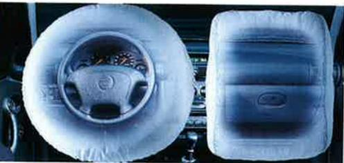
Seine Größe macht ihn so sicher: der Opel Full Size Airbag mit 67 Liter Volumen auf der Fahrerseite und 100 Liter auf der Beifahrerseite.
