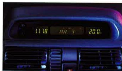
*Digitale Anzeige von Uhrzeit, Datum bzw. Radiofrequenz und Außentemperatur.*
