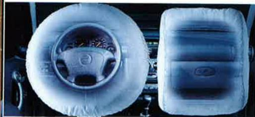
Seine Größe macht ihn so sicher: der Opel Full Size Airbag mit 67 Liter Volumen auf der Fahrerseite und 100 Liter auf der Beifahrerseite.
