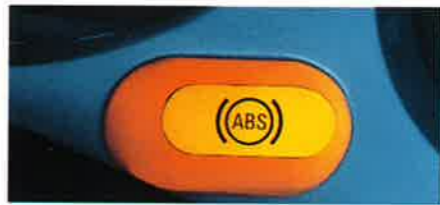
Damit Sie die Power des Tigra auch beim Bremsen sicher beherrschen, ist er serienmäßig mit elektronischem ABS ausgerüstet.
