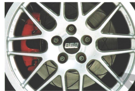
Zum sportlichen Fahren gehört eine zuverlässige Bodenhaftung durch breite Räder: BBS-Leichtmetallräder 7 1/2 x 17 mit Bereifung 215/45.
