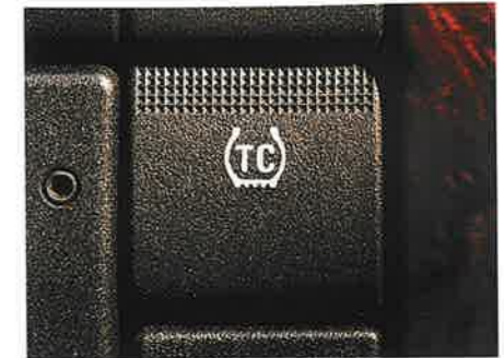
Traction Control, das heißt: perfekter Reifengriff auf jedem Belag. Bevor ein Rad durchdrehen kann, wird es elektronisch abgebremst (serienmäßig in Verbindung mit 2.0 16V ECOTEC- und 2.5 V6 ECOTEC-Motor).
