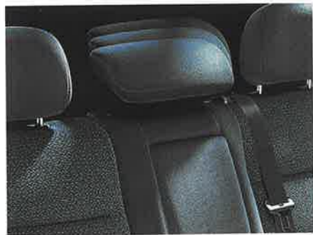
Im Basismodell Option, in jedem anderen Vectra serienmäßig: drei höhenstellbare Kopfstützen hinten und der dritte Dreipunktgurt auf dem mittleren Rücksitz.
