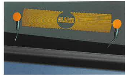
Immer da – auch wenn Sie weg sind. Die Diebstahlwarnanlage mit Ultraschallsensoren im Innenraum und Kontakten in allen Türen, Motorhaube, Kofferraum und Radio.
