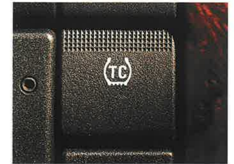
Traction Control, das nisch abgebremst (serienmäßig in Verbindung mit 2.2 16V ECOTEC- und 2.6 V6 ECOTEC-Motor).
