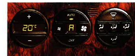
Wohlfühlen vorprogrammiert. Die FCKW-freie Klimatisierungsautomatik mit Temperaturvorwahl (serienmäßig im Vectra Elegance).
