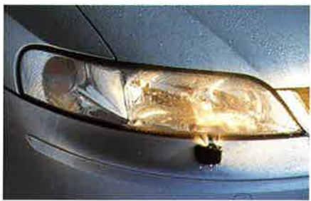
Erhöhte Sicherheit bei Nacht: Xenonscheinwerfer mit Hochdruck-Reinigungsanlage und dynamischer Leuchtweitenregulierung.
