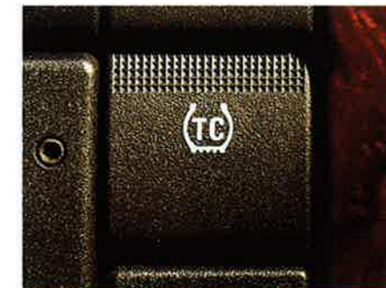
Traction Control, das heißt: perfekter Reifengriff auf jedem Belag. Bevor ein Rad durchdrehen kann, wird es elektronisch abgebremst (serienmäßig in Verbindung mit 2.2 16V ECOTEC- und 2.6 V6 ECOTEC-Motor).
