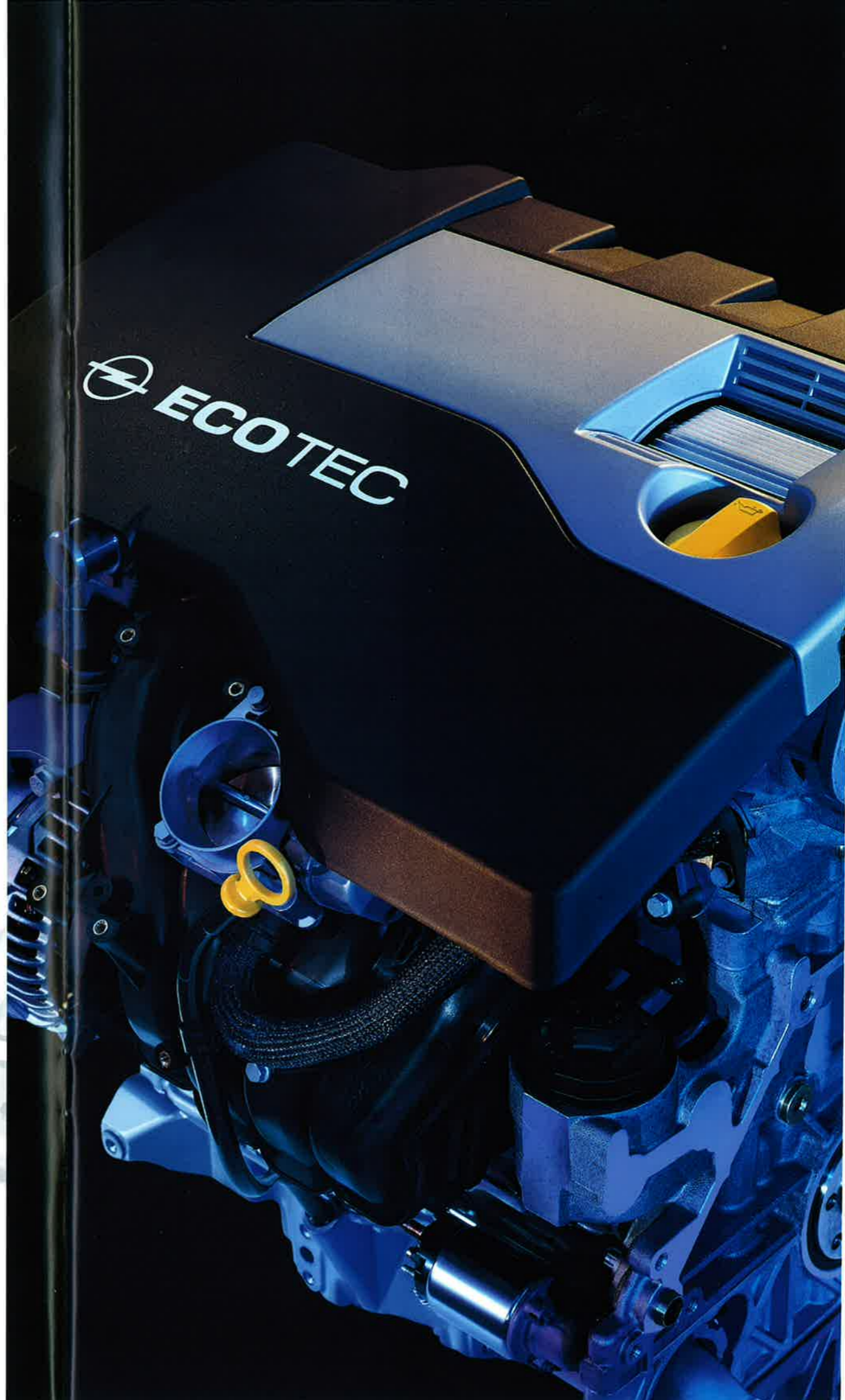
Leicht, lauffrig, leistungsstark und sparsam im Verbrauch. Der neue 2.2 16V ECOTEC-Leichtmetallmotor mit 108 kW (147 PS).
