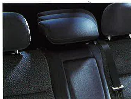
In jedem Vectra serienmäßig: drei höhenstellbare Kopfstützen hinten und der dritte Dreipunktgurt auf dem mittleren Rücksitz.
