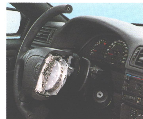
Der zusammengefaltete Airbag im Pralltopf des Lenkrades.
