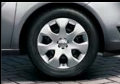
15"- bzw. 16"-Stahlrad inkl. Radabdeckung, 6½ J x 15 mit Reifen 195/65 R 15 (PA7) bzw. 6½ J x 16 mit Reifen 205/55 R 16 (PY3).
